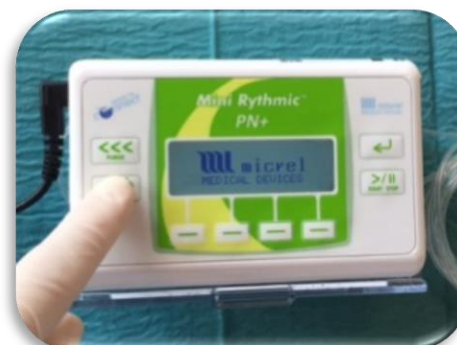
Tænd pumpen ved at holde "on/off"-knappen inde et par sekunder
